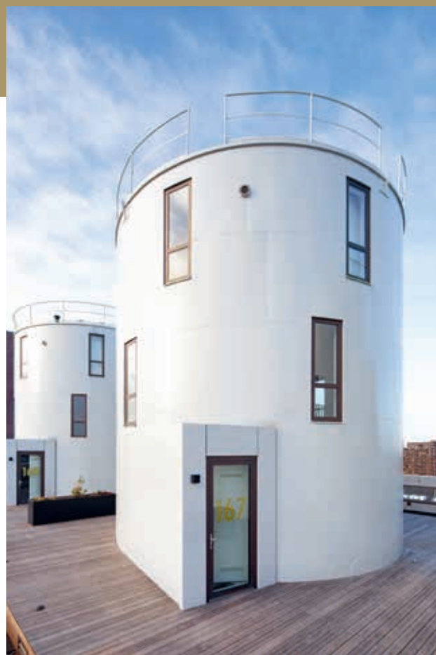
De silo's, grote ronde stalen voorraadvaten waar twee 'taartpunten' aan zijn toegevoegd. Foto: LEVS Architecten
